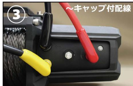
キャップをめくってボルトにはめて、付属のナットで締めこみます。ナットを締めこんだらナットにキャップを被せます。
