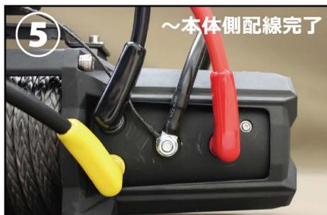
全ての配線が完了したらバッテリーへ配線をします。ナットはゆるみが無いようにしっかりと締めこんで下さい。
