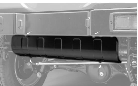
リアスキッドプレート本体とセンター バー、L字ブラケット を付属のボルト(M8)を使用して取り付けます。計4箇所
