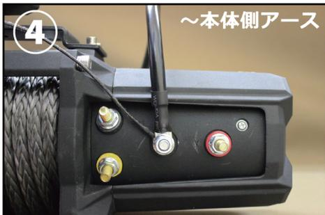
中央無色のボルトへ C-BOX 側のアース線と、別途付属のアース線を共締めします。
