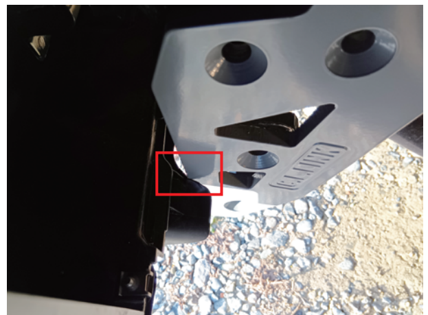
3型以降車両のバンパー干渉事例
