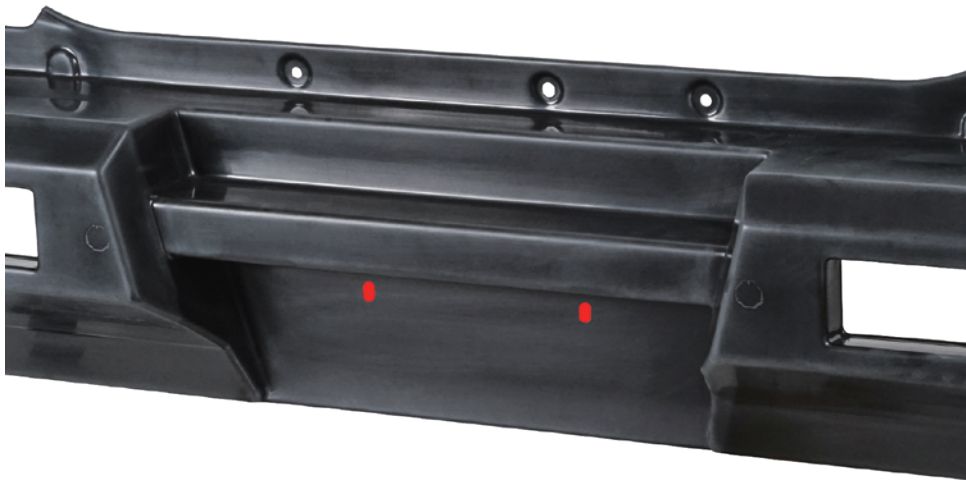
ナンバープレート、車両側ステーと穴位置を合わせて拡張
