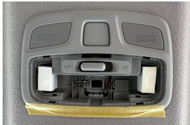
高さ調整スポンジの貼り付け
