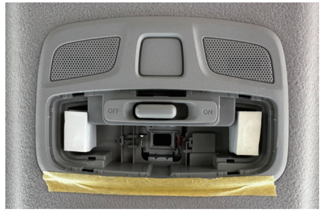
高さ調整スポンジの貼り付け
